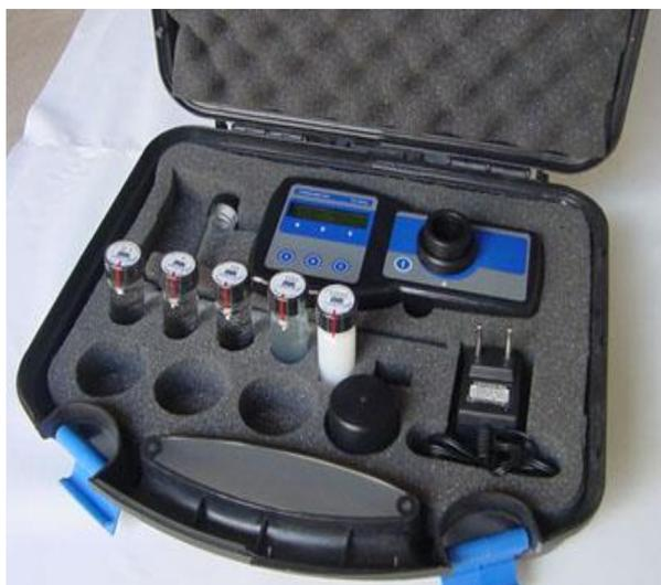
Figura 4: Turbidímetro. O equipamento é adaptado para ser usado em campo.
