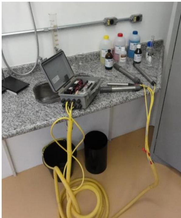
Figura 3: Sonda multiparamétrica no LIM para verificação. Ao lado dos sensores encontram-se as soluções padrões utilizadas para verificação.
