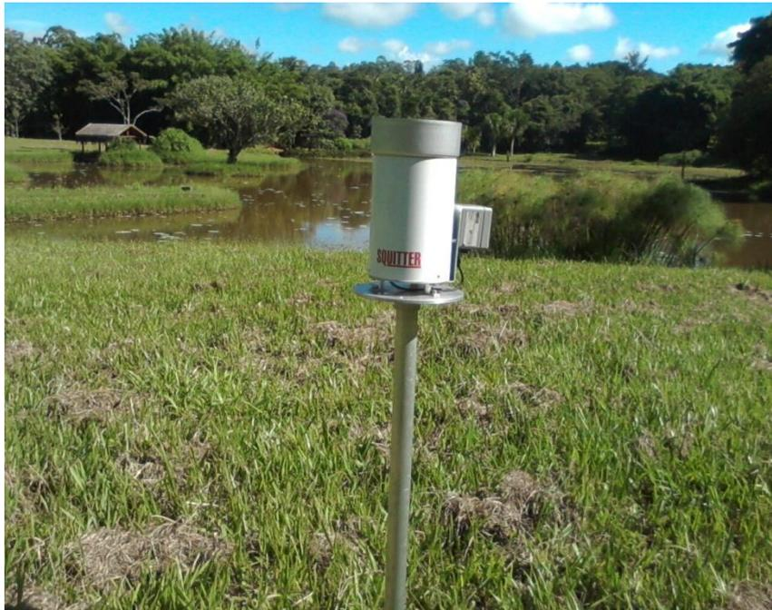
Figura 6: Pluviômetro instalado na Antiga Fazenda da Conceição
