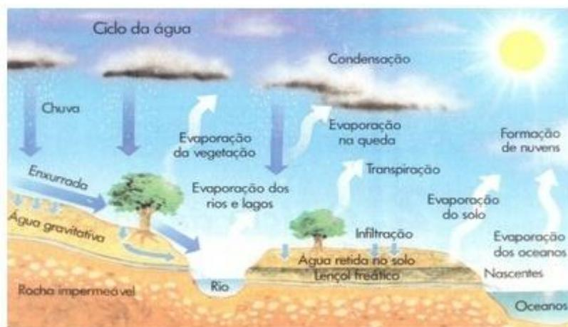
Figura 2.1- O ciclo da água (precipitação, infiltração, evapotranspiração, escoamento superficial e subterrâneo).
